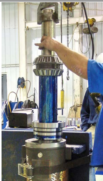
Подшипниковый узел, вставленный в приводную часть корпуса
