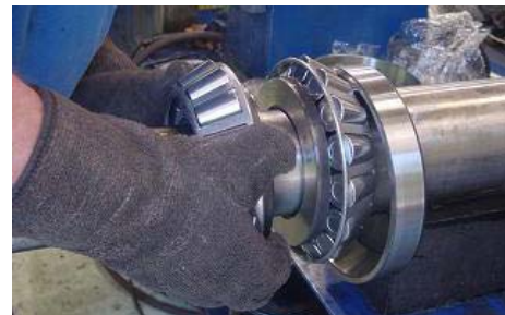
Схема расположения несущего подшипника с лицевым расположением роликов
