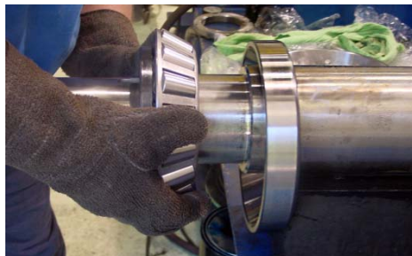
Схема расположения несущего подшипника с лицевым расположением роликов
