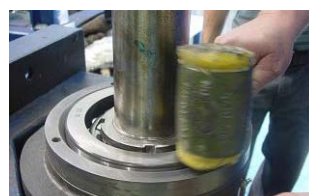
Для облегчения запрессовки используйте резиновый молоток
