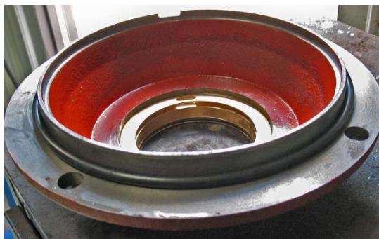
Установите с желобом возврата смазки в положении 6 часов
