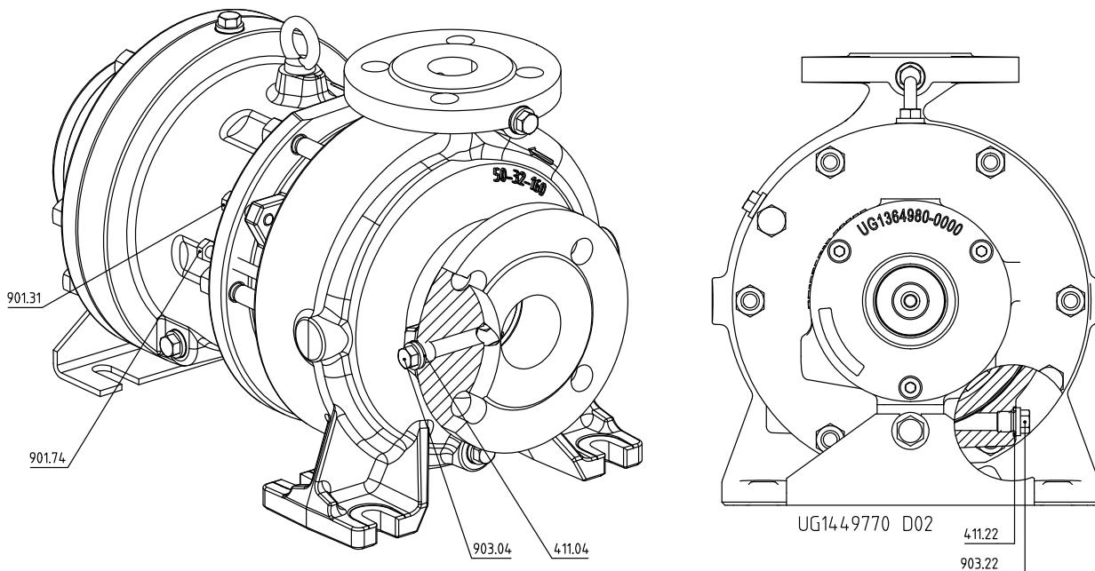
Рис. 34: Крепление крышки корпуса с напорной стороны на корпусе насоса для исполнения с зажимной крышкой
