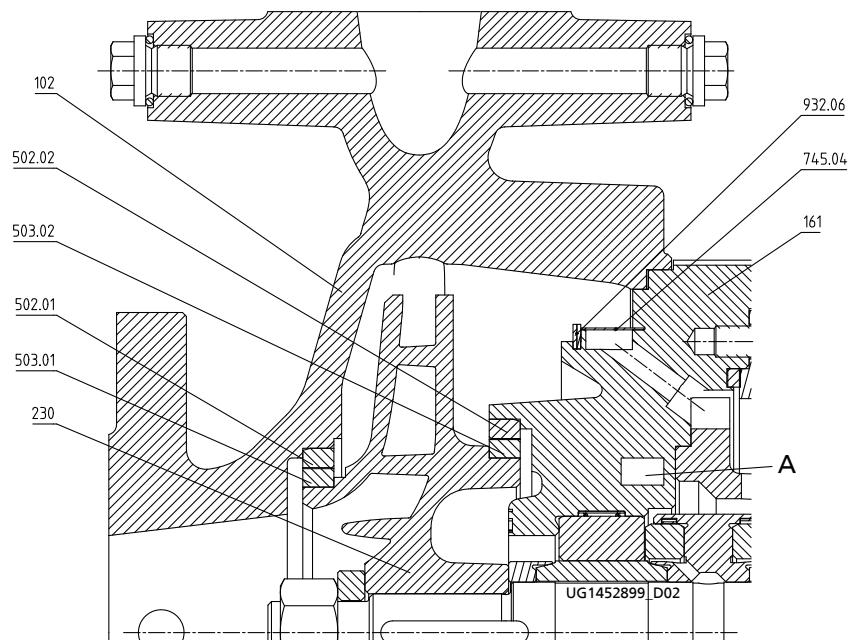
Рис. 35: Исполнение спирального корпуса с кольцевым фильтром, камерой обогрева, щелевыми кольцами и щелевым кольцом рабочего колеса
