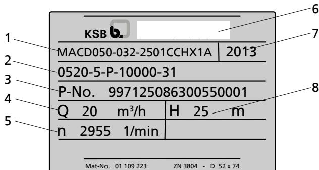
Рис. 5: Заводская табличка (пример)
