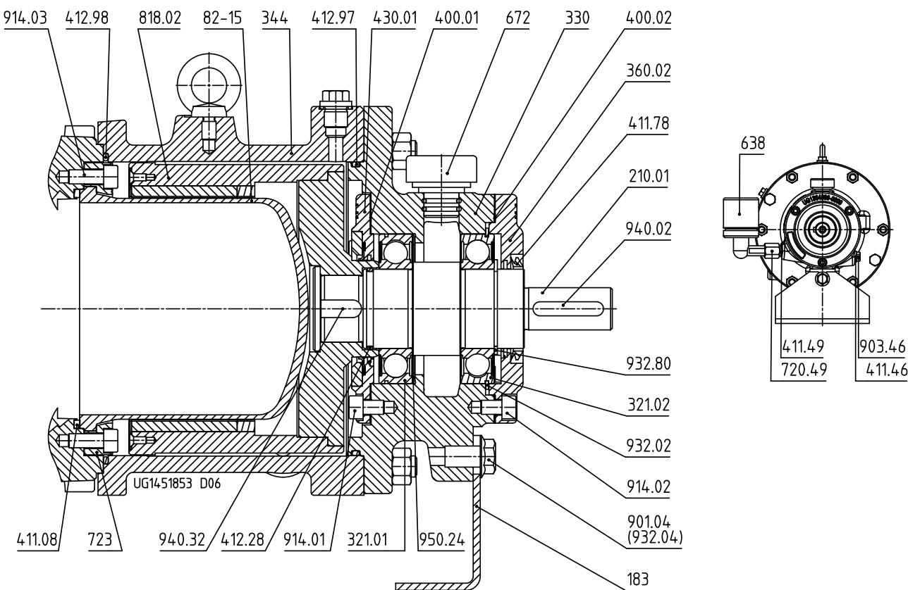
Рис. 38: Исполнение подшипникового кронштейна с жидкой смазкой и Lip-уплотнением вала, обеспечивающим защиту от утечек
