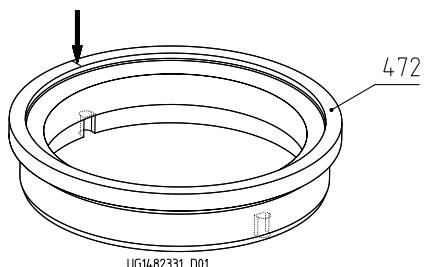
Рис. 27: Маркировка положения паза на вращающемся кольце 472
