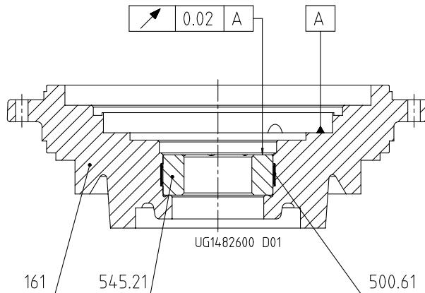
Рис. 22: Проверить биение втулки подшипника относительно крышки корпуса
