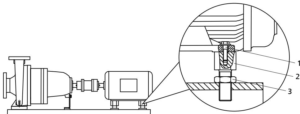
Рис. 14: Двигатель с регулировочным винтом
