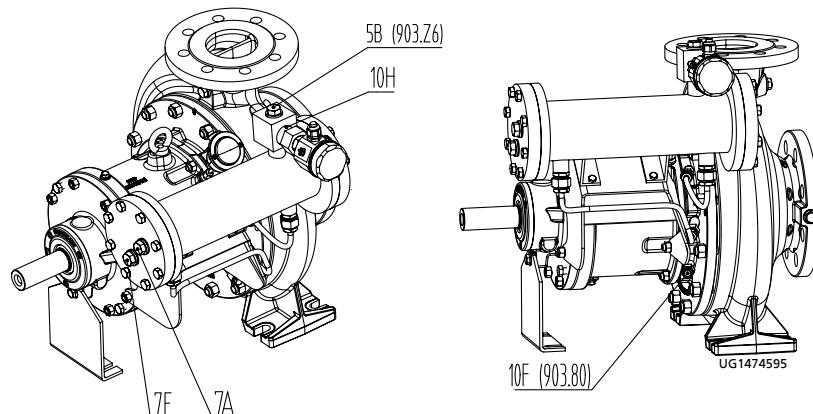
Рис. 17: Подсоединения насоса, оснащенного теплообменником («замкнутый контур»)
