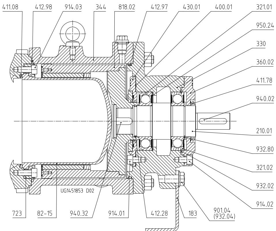
**Рис. 36:** Исполнение подшипникового кронштейна с консистентной смазкой и Lip-уплотнением вала, обеспечивающим защиту от утечек
