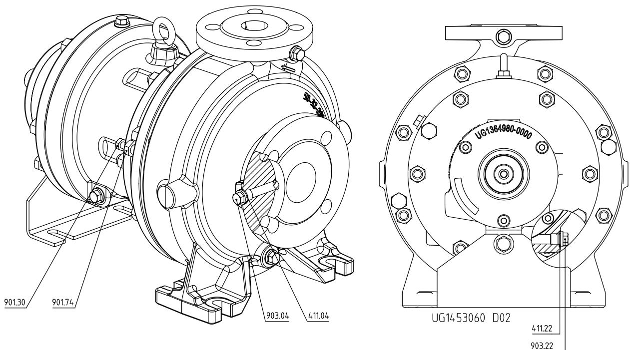
Рис. 32: Крепление крышки корпуса с напорной стороны на корпусе насоса для исполнения с привинчивающейся крышкой
