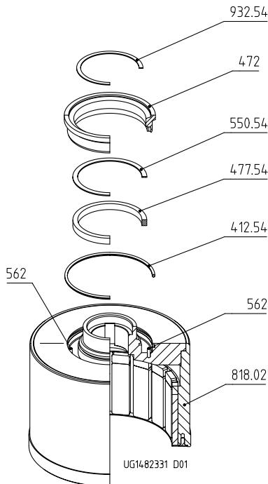
Рис. 28: Монтаж торцевого уплотнения на внешнем роторе
