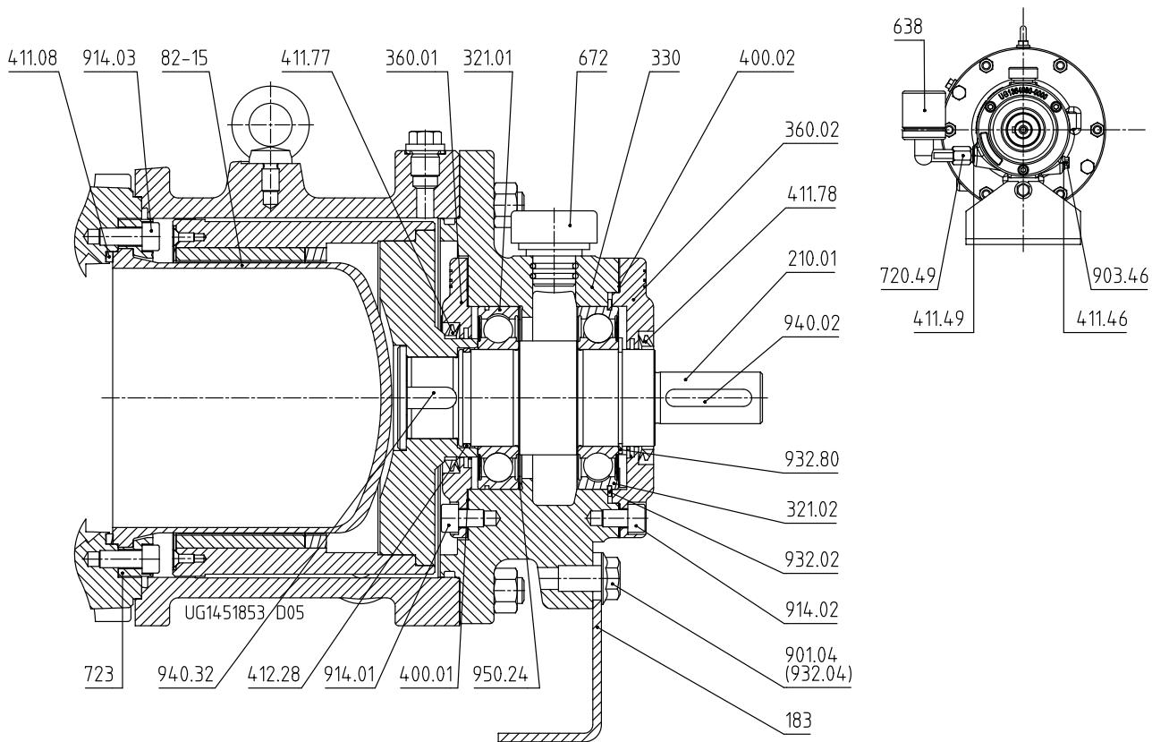
Рис. 37: Исполнение подшипникового кронштейна с жидкой смазкой без Lip-уплотнения вала, обеспечивающего защиту от утечек
