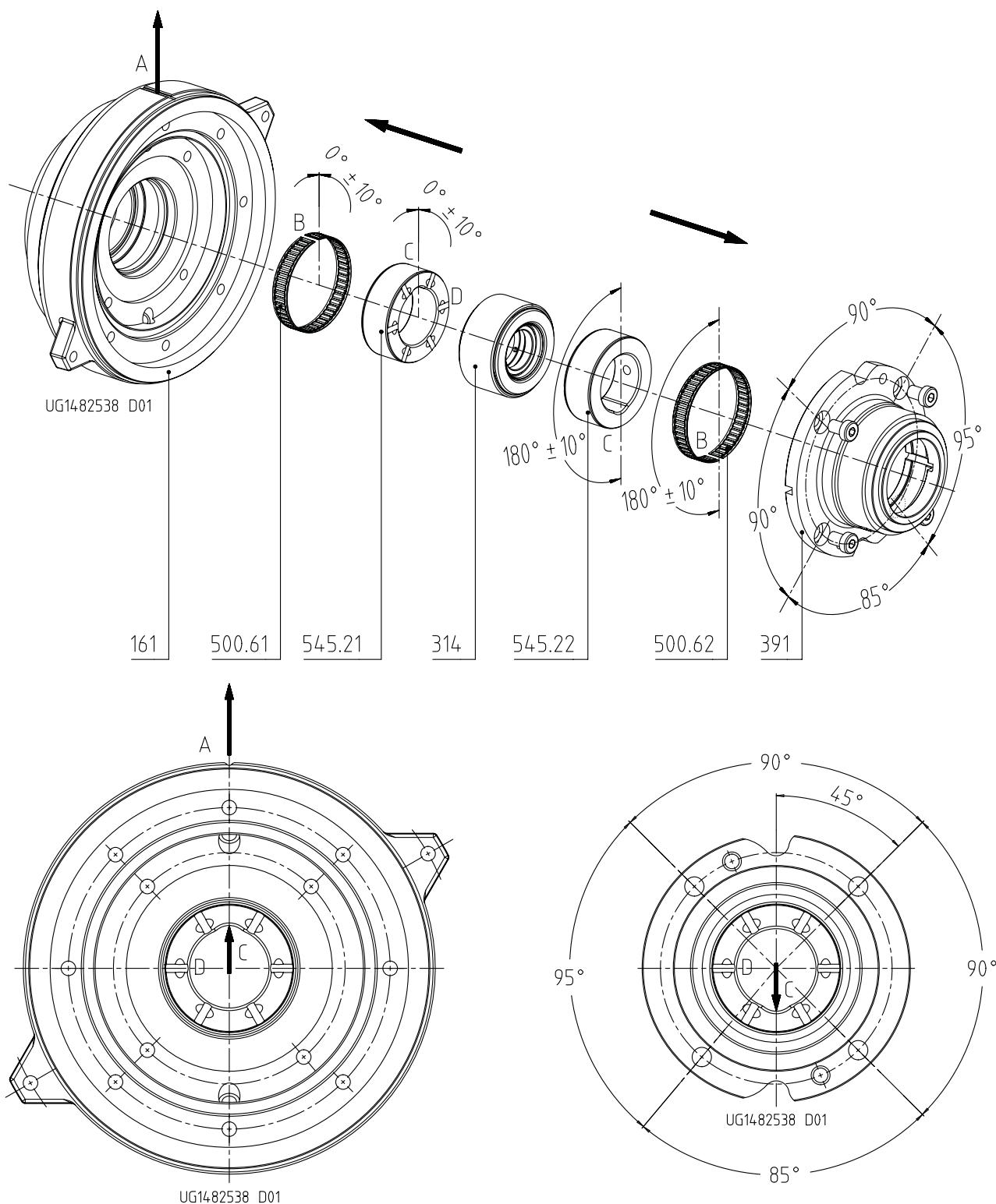
Рис. 39: Позиционирование зажимных элементов и втулок подшипника для подшипникового кронштейна CS40/CS50/CS60
