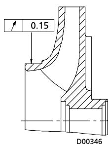
Рис. 30: Проверка радиального биения рабочего колеса
