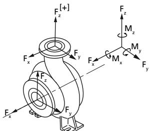
Рис. 10: Силы и моменты, действующие на патрубки насоса
