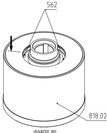
Рис. 26: Маркировка положения штифта 562 на фланце внешнего ротора 818.02
