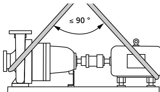
Рис. 3: Транспортировка насосного агрегата
