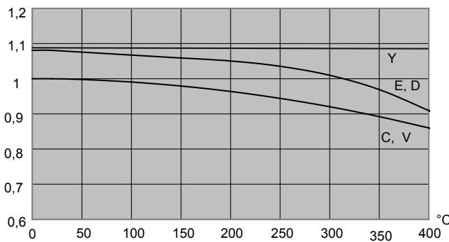
Рис. 11: График температурной коррекции для исполнений С, D, E, V, Y (1.4408/A743 GR CF8M)
