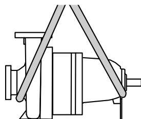
Рис. 2: Транспортировка насоса
