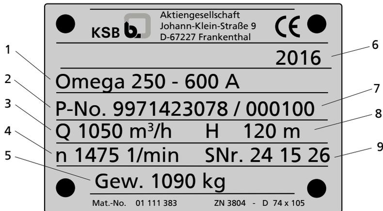
Рис. 2: Заводская табличка (пример)
